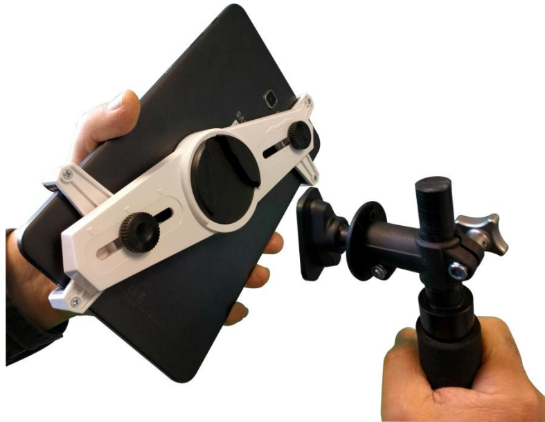
5.2 - Montage de la Tablette avec tige télescopique de la sonde universelle
