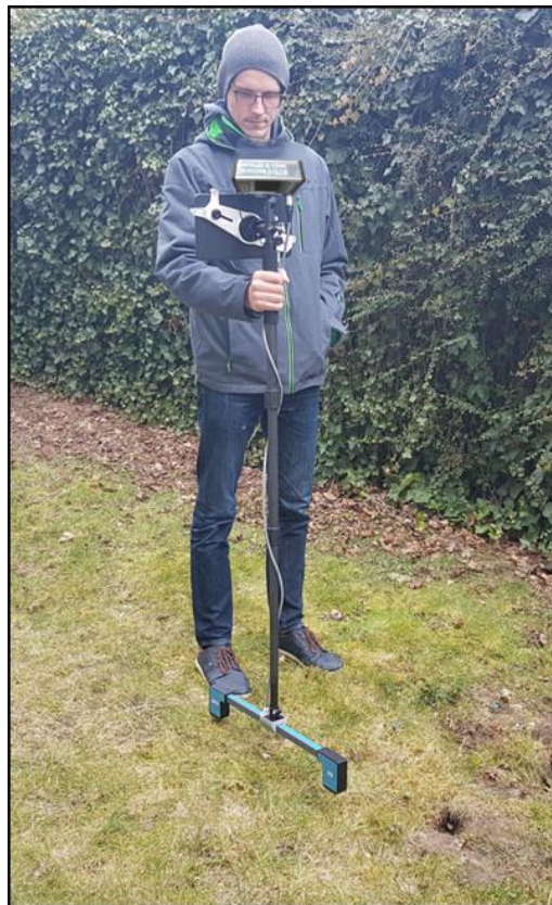
2.5 - Universalsonde mit Tablet Computer
